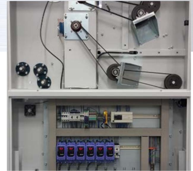
del codificador en combinación con células fotoeléctricas libres (sin uso de espejos). La FlexFold LP300-400 está diseñada para ser usada de por vida y es de fácil mantenimiento. Por ejemplo, los sistemas de accionamiento para ambas secciones, la principal y el plegado en cross son libres de mantenimiento. Además, el eje de los rodillos se brida en el extremo del rodillo, lo que es muy simple y fácil de reemplazar.
