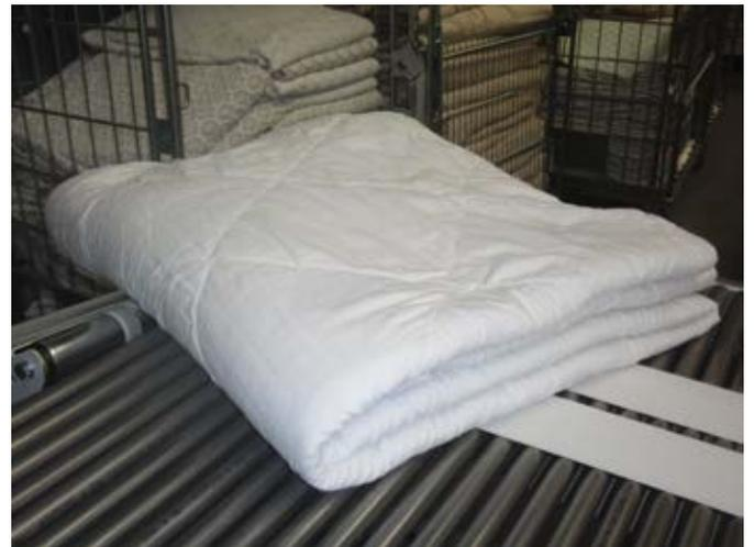
Nach der ersten Längsfaltung werden, die Teile zwischen den Bändern zur nächsten Längsfaltung transportiert. Um die Konsistenz und Qualität zu gewährleisten, werden doppelte Blas-Rohre in der Längsfaltung angewendet.
