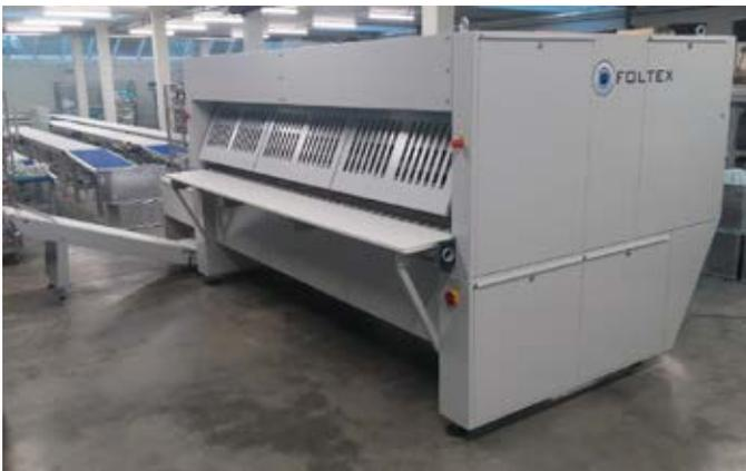
Die FlexFold BT300 ist eine hochflexible Eingabe- Falt- und Stapel -Kombination für die Bearbeitung von unterschiedlichen dünnen und dicken Decken, bis zu einer Abmessung von 300x300cm.
