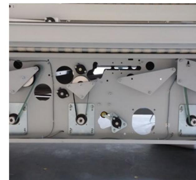
contrôlée. Le 1er pli transversal est assuré par couteau et le 2nd (pour grand plat seulement) par combinaison de bandes réversibles et couteau (by-pass du 2nd pli transversal possible). Le 3e pli transversal est assuré par couteau et tapis d'avalement. Les empileurs peuvent être indifféremment positionnés à gauche ou à droite. La plieuse FlexFold LP300-400 peut être commandée sans section de pliage transversal.
